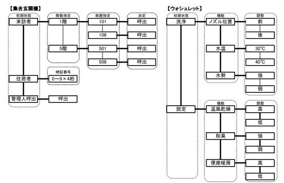
本図のツリー検索表示例は、「有機ELディスプレイロッカIS」の使用方法を簡易的I示したもので、実際の状態・設定と異なる場合があります。
